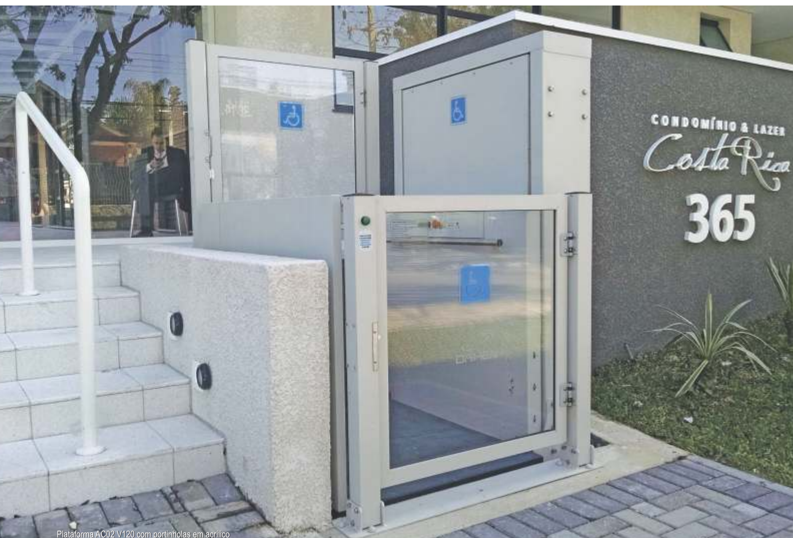
Plataforma AC02 V120 com portinholas em acrílico
